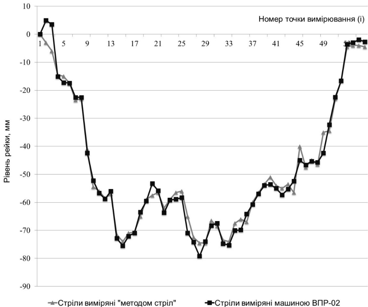
Рис. 6 — Суміщений графік вимірювань «методом стріл» та результатів вимірювального заїзду машини типу ВПР після виправки залізничної колії.
